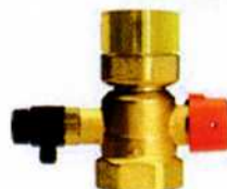
Fig. 4: La vanne à coiffe permet d'isoler le vase de l'installation pour le purger ou le vider de son eau.
